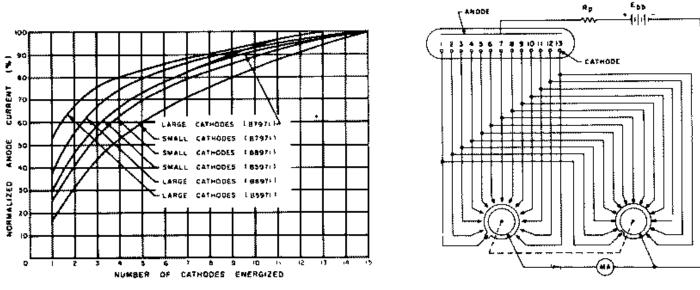
Figure 7. ANODE CURRENT DISTRIBUTION
