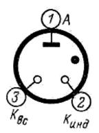
Линейный индикатор тлеющего разряда для непрерывного контроля в устройствах индикации и сигнализации.
