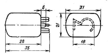
Выводы электродов: 1 — анод; 2 — цифра 0; 3 — цифра 9; 4 цифра 8; 5 — цифра 7; 6 — цифра 6; 7 цифра 5; 8 — цифра 4; 9 — цифра 3; 10 цифра 2; 11 — цифра 1; 12 — не подключен (у ИН-12Б вывод 12 — знак «запятая»).
